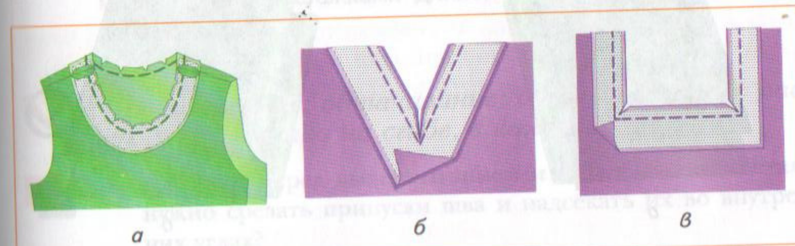
Рис. 94 Надсечение припусков шва: а — по вогнутому внутреннему контуру; б, в — во внутренних углах
