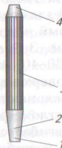
Рис. 51 Зубило: 1 — режущая кромка; 2 — боковая поверхность лезвия; 3 — стержень; 4 — ударная часть
