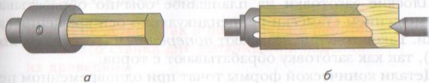
Рис. 34 Крепление детали: а — в патроне винтом; б — трезубцем с поджатием конусом задней бабки
