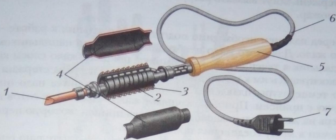
Рис. 32. Устройство паяльника: 1 – медный стержень с жалом; 2 – металлическая трубка; 3 – нагревательный элемент; 4 – кожух; 5 – ручка; 6 – питающий шнур (провод); 7 – вилка
