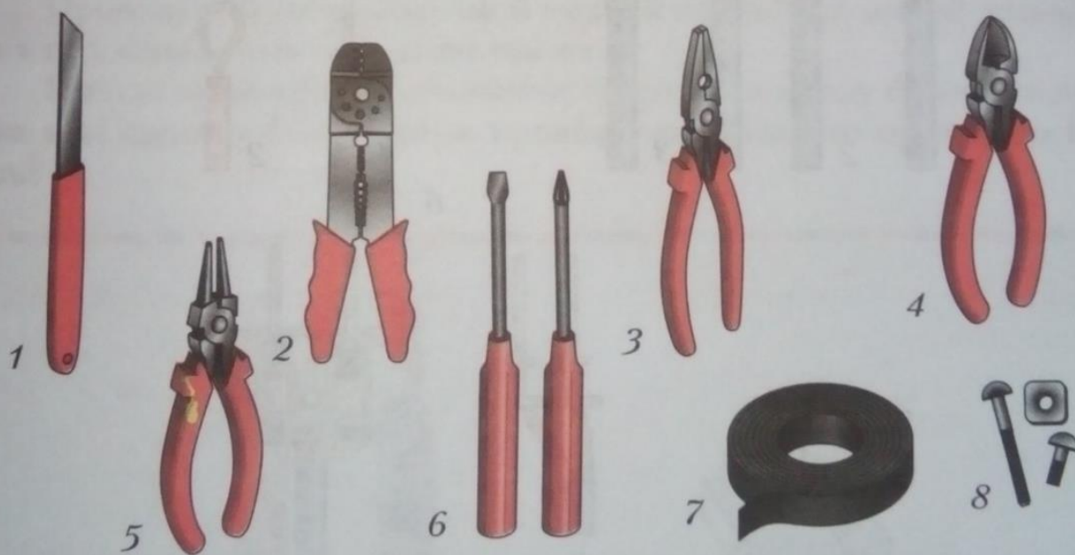
Рис. 34. Электромонтажные инструменты, материалы и крепёжные изделия: 1 – монтажный нож; 2 – приспособление для снятия изоляции; 3 – плоскогубцы; 4 – кусачки-бокорезы; 5 – круглогубцы; 6 – отвёртки; 7 – изоляционная лента; 8 – крепёжные изделия
