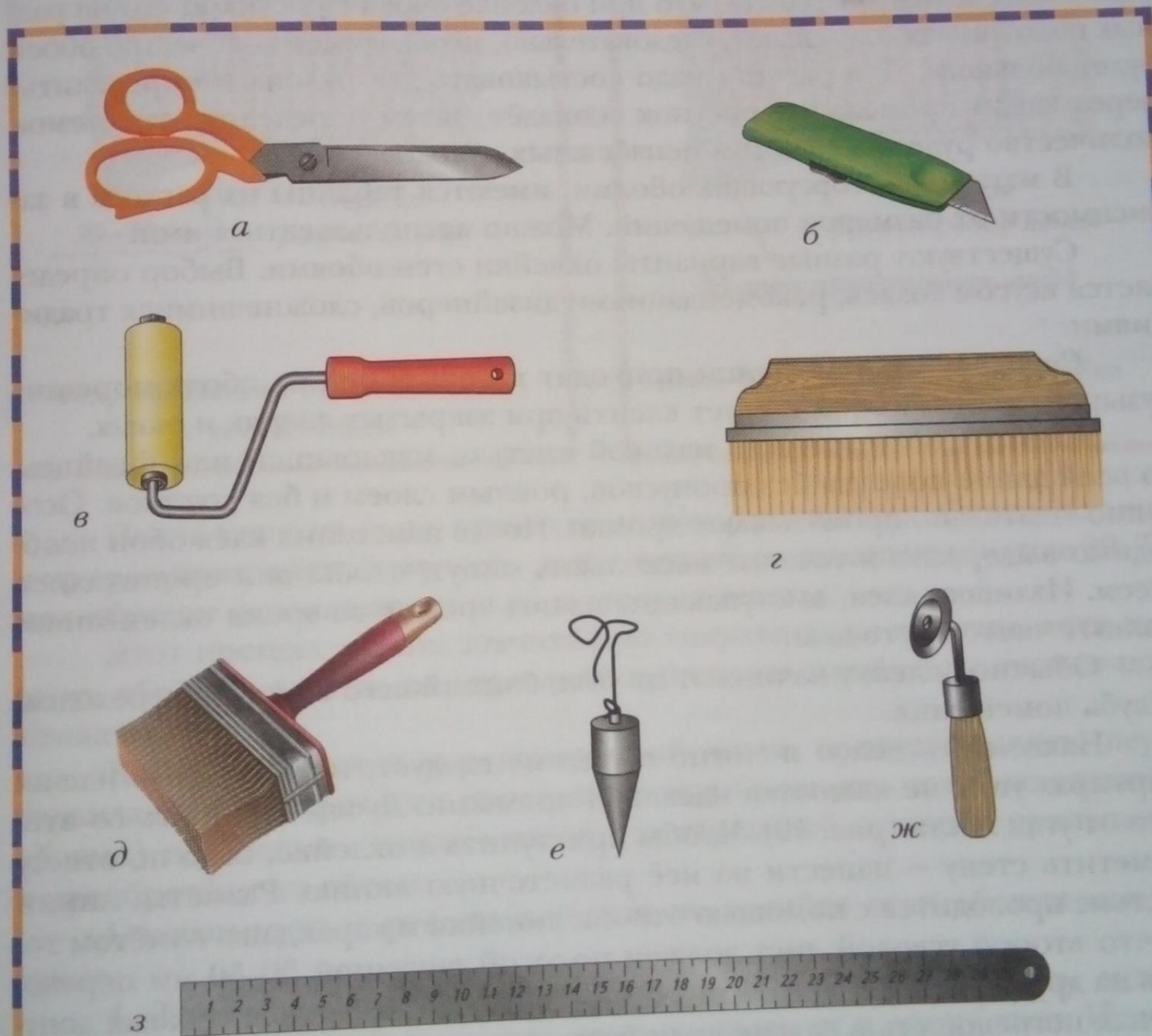
Рис. 18. Инструменты и приспособления для обоечных работ: а — ножницы; б — малярный нож; в — валик для разравнивания наклеенных обоев; г — щётка для разглаживания обоев; д — кисть для нанесения клея; е — отвес; ж — роликовый нож; з — линейка
