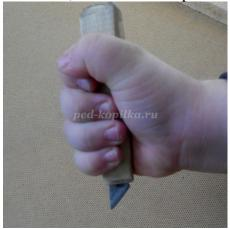
С небольшим наклоном вправо «проходим» резцом по линии (глубина2-3мм)
