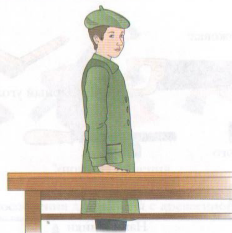
Рис. 89. Соответствие высоты верстака росту работающего
