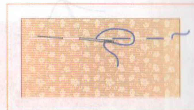
Рис. 91 Перенос линий выкройки на детали кроя прямыми стежками
