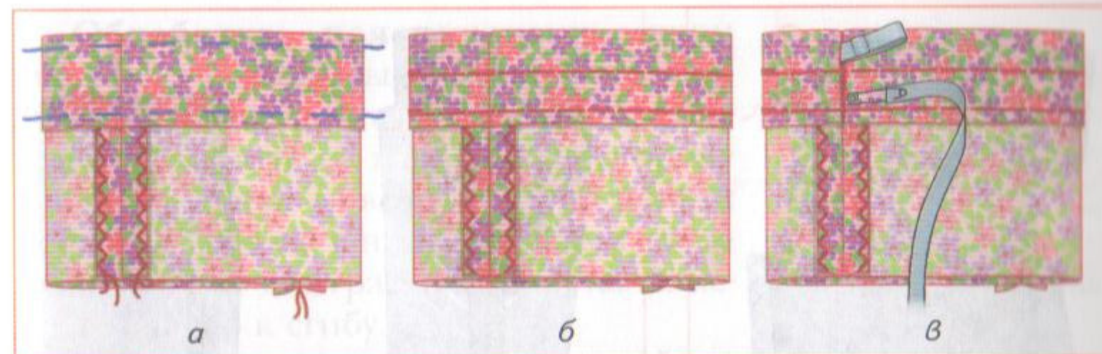
Рис. 116 Обработка пояса-кулиски юбки: а — замётывание; б — застрачивание; в — продевание резиновой тесьмы
