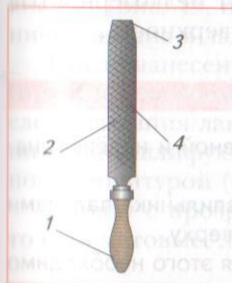
Рис. 46 Напильник: 1 — ручка; 2 — стержень; 3 — носок; 4 — насечка
