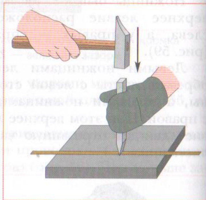
Рис. 61 Разрубание проволоки зубилом
