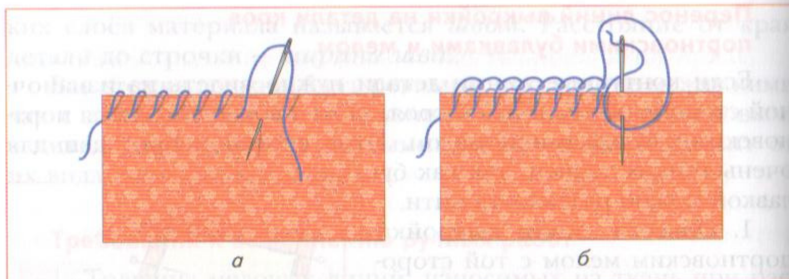
Рис. 92 Обмётывание косыми (а) и петельными (б) ручными стежками
