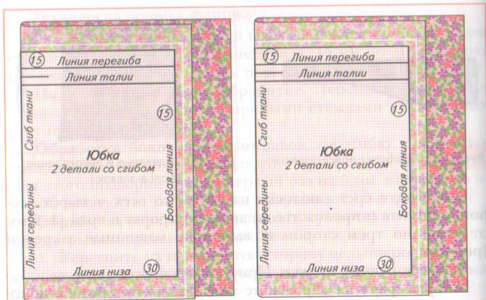
Рис. 114 Раскладка выкроек юбки на ткани
