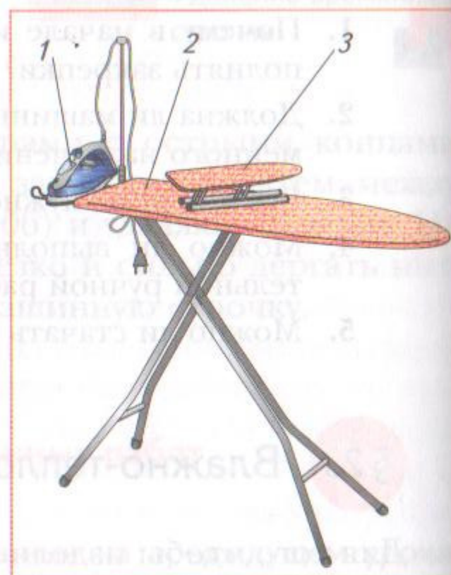
Рис. 107 Оборудование для влажно-тепловой обработки: 1 — утюг; 2 — утюжильная доска; 3 — приспособление для утюжки маленьких деталей
