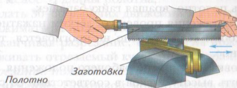
Рис. 63. Прорезание шлицев и пазов шлицовкой
